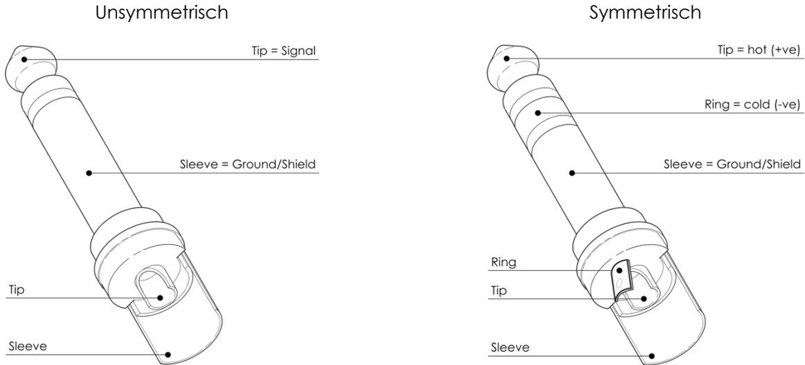
Für diese Anwendungen ist das Gerät mit 3,65-mm-Anschlüssen (TRS und XLR) ausgestattet, die die Verbindung mit den meisten professionellen Audiogeräten ermöglichen. Beachten Sie die folgenden Konfigurationsbeispiele für Ihre eigenen Anschlüsse.
