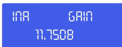
Regolare il gain agendo sul **jogwheel (8)**. Premere il pulsante **item up (2)** per procedere con l'elemento successivo. Nel nostro esempio si tratta del filtro Lowpass.
