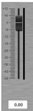
Il cursore gain mostra l'impostazione reale di guadagno del canale. Il blocco di testo sotto al cursore del guadagno mostra il valore esatto del guadagno. Consente di regolare il gain complessivo di ogni canale di output. Regolare il gain digitando il valore nella casella o facendo clic e trascinando il cursore.
