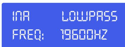
Regolare agendo sul **jogwheel (8)**. Sarà possibile spegnere il filtro lowpass agendo sul **jogwheel (8)** in senso orario fino a che la frequenza non supera i 20kHz. Fare clic sul **jogwheel (8)** per modificare il tipo di filtro.
