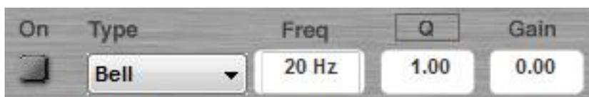
Entrambi i canali in ingresso hanno fino a un massimo di 10 EQ parametrici. Ogni equalizzatore parametrico può essere configurato come Allpass, Bell, High shelving, Low shelving o filtro Notch filter.
