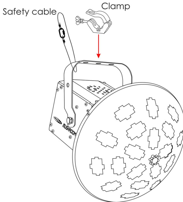
Der Small Mushroom LED Q6 kann mit einer Schelle an einem beliebigen Traversenrahmen befestigt werden.
