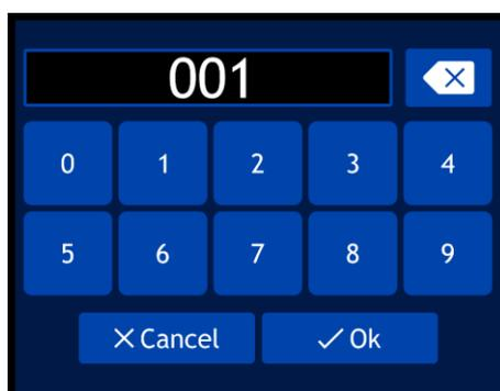
02) Ruotare il controllo o digitare l'indirizzo DMX desiderato. La gamma di regolazione varia da 001 a 512.
