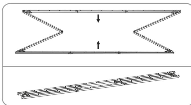
07) Aprire i lati orizzontali del telaio principale di modo che il telaio sia completamente piegato.
